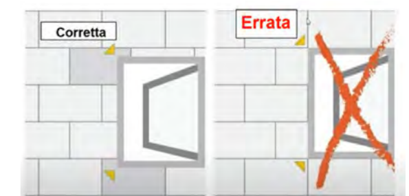
Posizionamento dei pannelli isolanti in prossimità delle aperture
